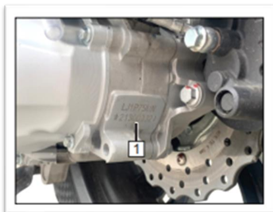
1 - Nº de motor O nº de motor está gravado no cárter, conforme figura 1.
