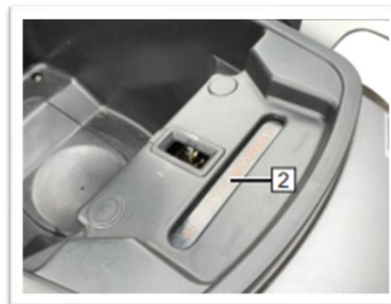
2 - Nº de identificação do veículo (VIN) O VIN encontra-se gravado debaixo do banco na parte traseira do baú.
