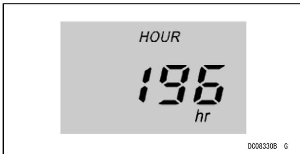
O contador de horas apresenta o total de horas de funcionamento da embarcação. Este indicador não pode ser reposto a zero.
