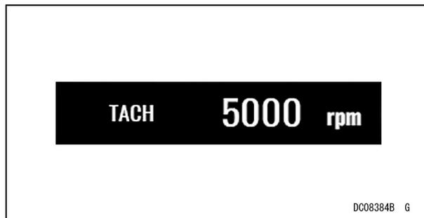
Este conta-rotações é digital e indica a velocidade do motor em rotações por minuto (rpm).
