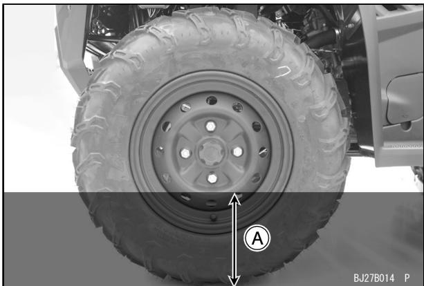
A. Profundidade máxima de passagem em água
