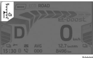
Mostra a temperatura das baterias de açãoamento do motor.
