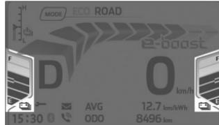
Mostra a capacidade elétrica restante das baterias de açãoamento do motor em vários segmentos. Os indicadores esquerdo e direito correspondem às ranhuras da bateria do veículo.
