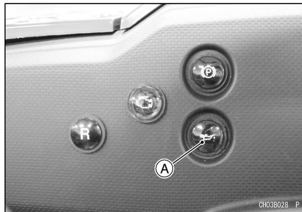
A. Indicador luminoso de aviso vermelho da temperatura do óleo do motor
