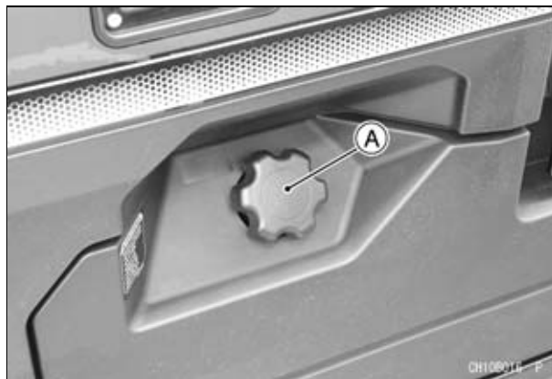
A. Tampão do depósito de combustível
