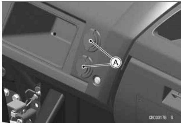
A. Tomadas eléctricas
