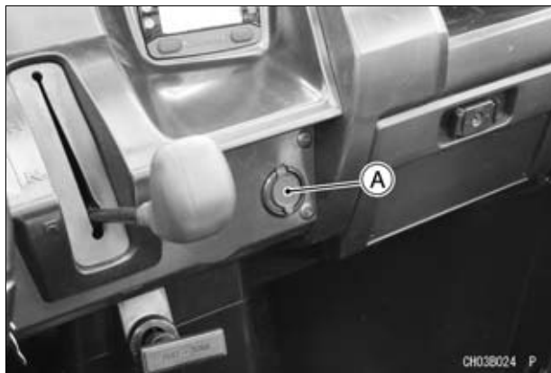
A. Tomada eléctrica
