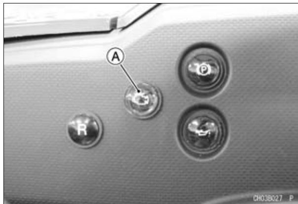
A. Luz de aviso de injeção de combustível
