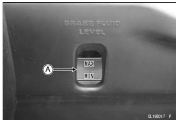
A. Orifício de inspeção
