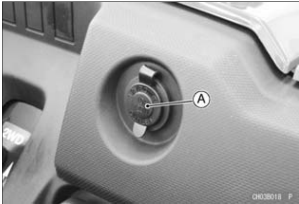
A. Tomada eléctrica
