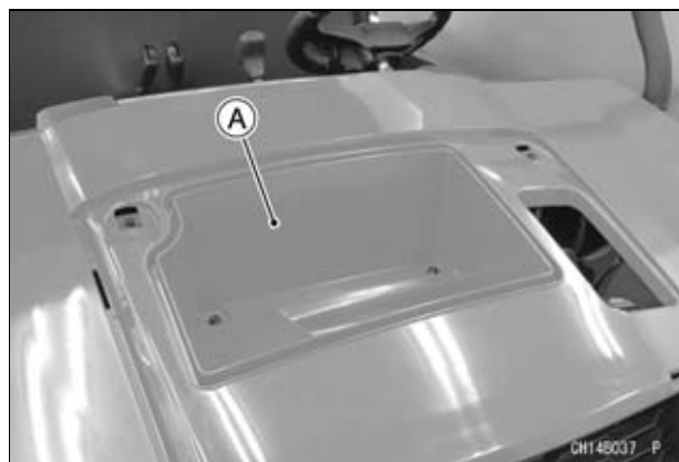
A. Compartimento de armazenamento dianteiro
