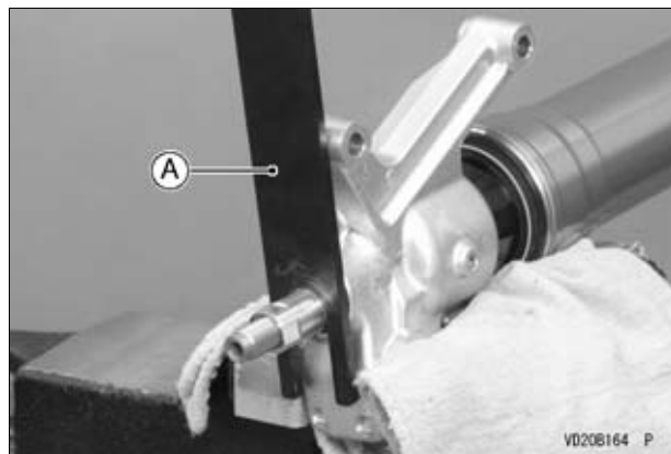
A. Chave de tampão superior, 49 mm (ferramenta especial: 57001-1653)
