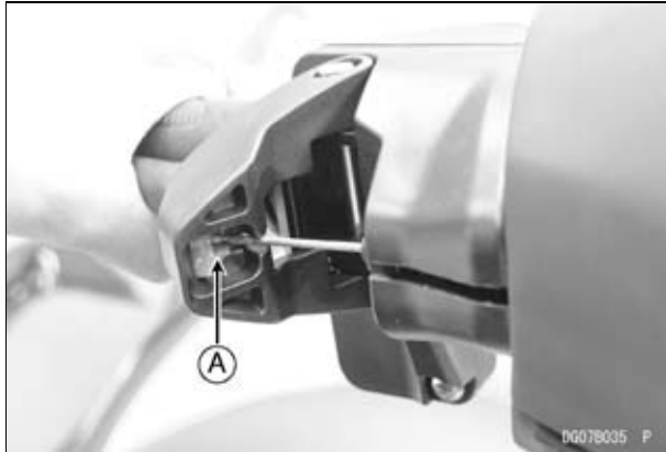
A. Aplicar o lubrificante.
