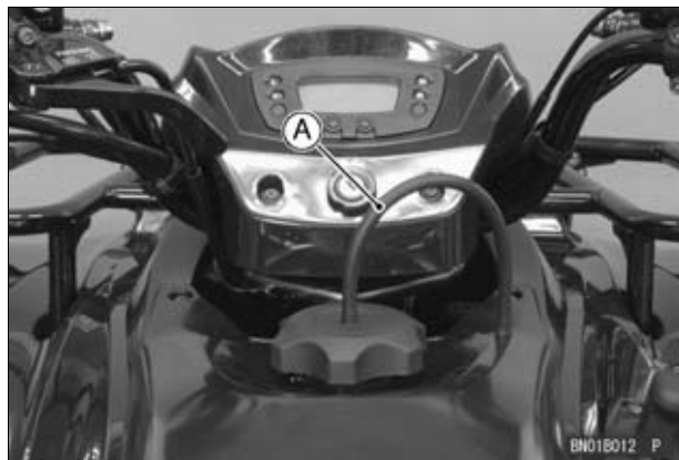
A. Tubo de ventilação do tanque de combustível
